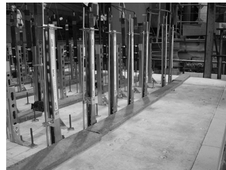
2: Mérőrendszer a rendszer tüzeseti viselkedésének kiértékelésére
