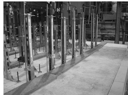
2: Mérőrendszer a rendszer tüzeseti viselkedésének kiértékelésére
