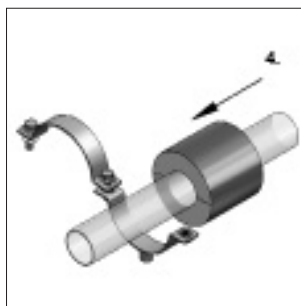
A csőre helyezett betétet a bilincshez pozicionálni. opcionális: fémcilinderrel
